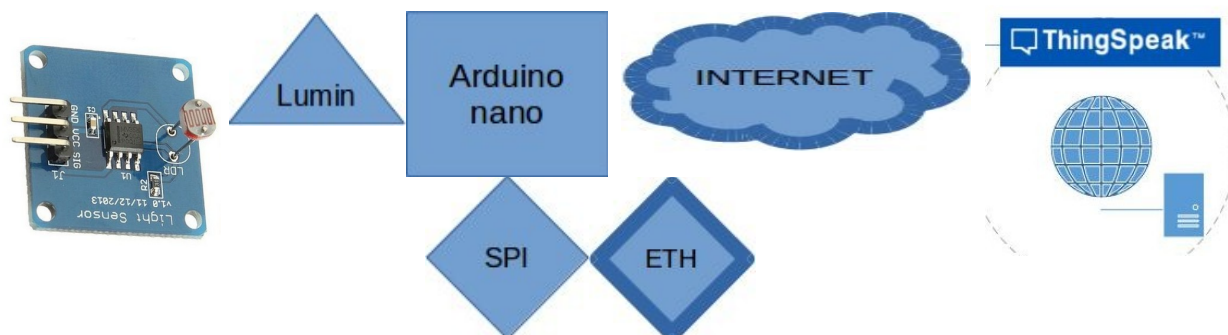
Figure 2.7 L'architecture IoT avec un client WEB (bibliothèque ThingSpeak.h) et le serveur ThingSpeak sur le réseau local
