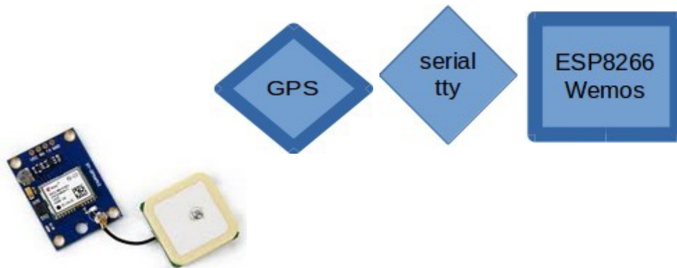
Figure 3.5. NEO-6M GPS module connecté à la carte Wemos D1 par la biais d'un bus UART
