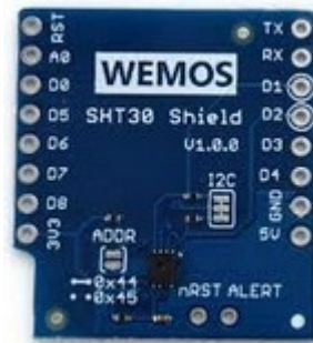
Figure 3.2 SHT30 shield pour Wemos D1 Wemos D1
