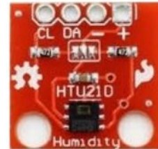
Figure 1.3 IoT DevKit : carte d'extension multi I2C et un capteur de température/humidité HTU21D
