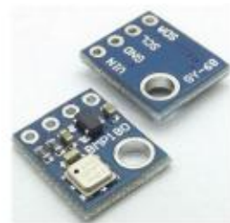
Figure 1.6. IoT DevKit : carte d'extension multi I2C et un capteur de pression/température BMP180
