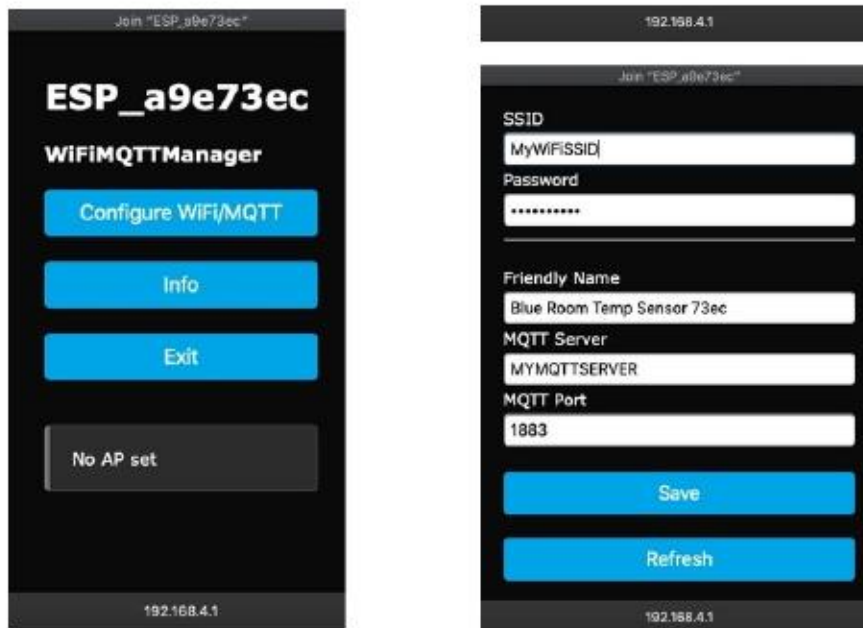
Figure 3.3 Pages WEB de WiFiMQTTManager pour la configuration du mode de passe et de l'adresse IP du serveur MQTT .
