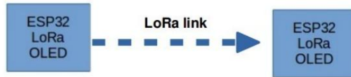
Figure 3.1 Un lien LoRa avec un émetteur et un récepteur
