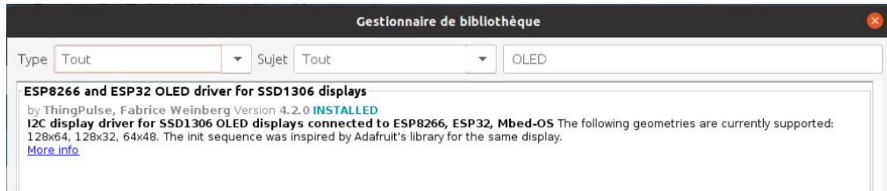
Figure 0.7. Intégration d'une bibliothèque Arduino ( SSD1306Wire.h )
